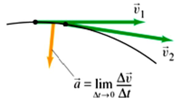
Questo cambiamento di direzione della velocità è **causato da un'accelerazione vettoriale istantanea** che risulta essere rappresentata da un vettore **perpendicolare alla velocità e diretto sempre verso l'interno della curva.**
